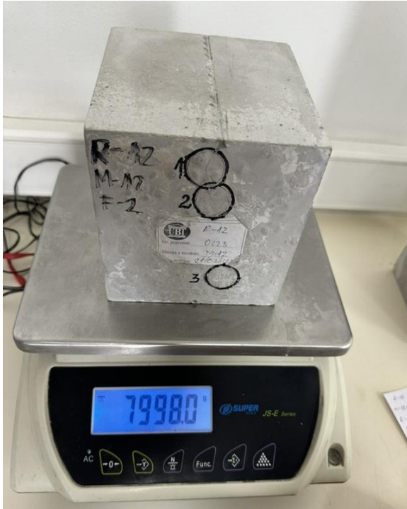
Masa e mostrës R-12, M-12 – Crack
