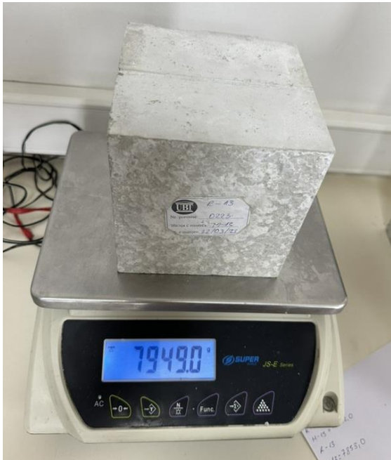
Masa e mostrës R-13, M-12 – Crack
