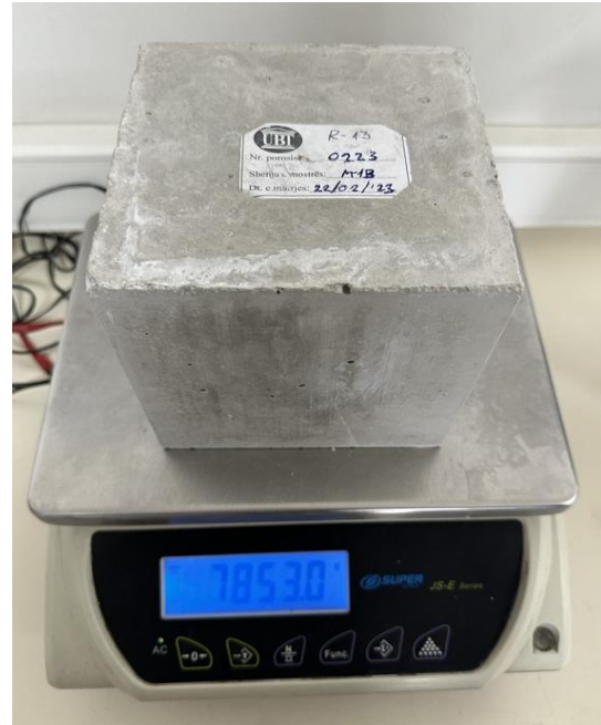
Masa e mostrës R-13, M-13 – No Crack
