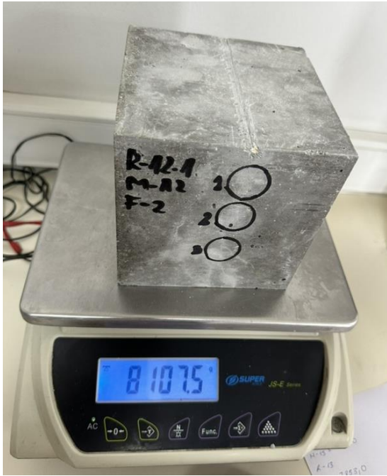
Masa e mostrës R-12.1, M-12 – Crack
